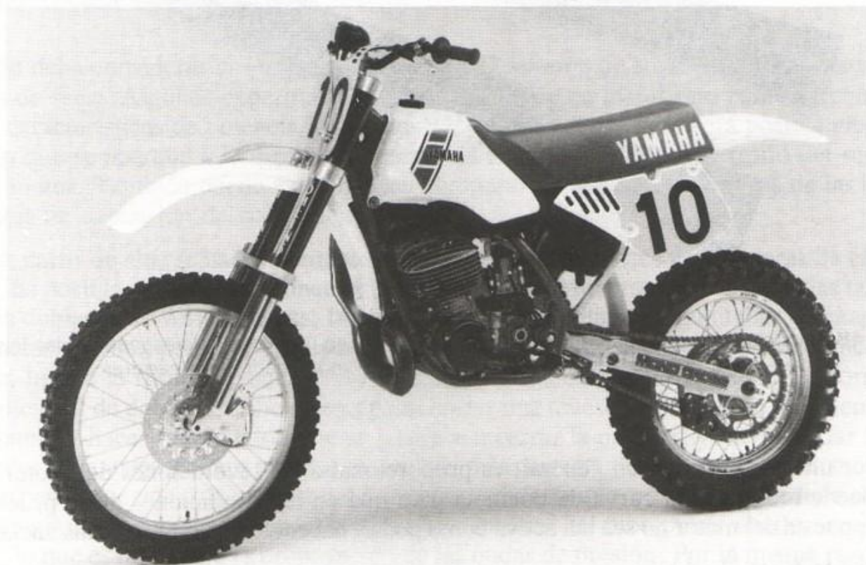
Fig. 47. En las motos de motocross es necesario dar una forma complicada al sistema de escape, para que no se acerque demasiado al suelo.
