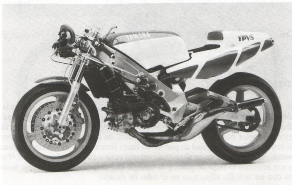
Fig. 45. Moto del equipo Yamaha de las carreras de GP de 500 c.c. de 1985. Adviértase el sistema de escape de forma cónica en toda su longitud, y la forma complicada que se le tuvo que dar para poder instalarlo en la moto sin que se acercase demasiado al suelo y sin que aumentase la anchura total de la moto.
